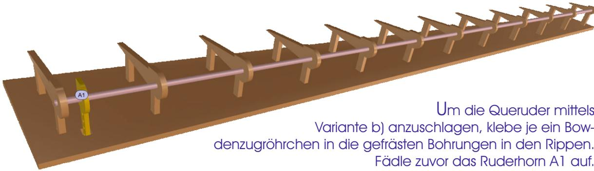
Um die Queruder mittels Variante b) anzuschlagen, klebe je ein Bowdenzugröhrchen in die gefrästen Bohrungen in den Rippen. Fädle zuvor das Ruderhorn A1 auf.
