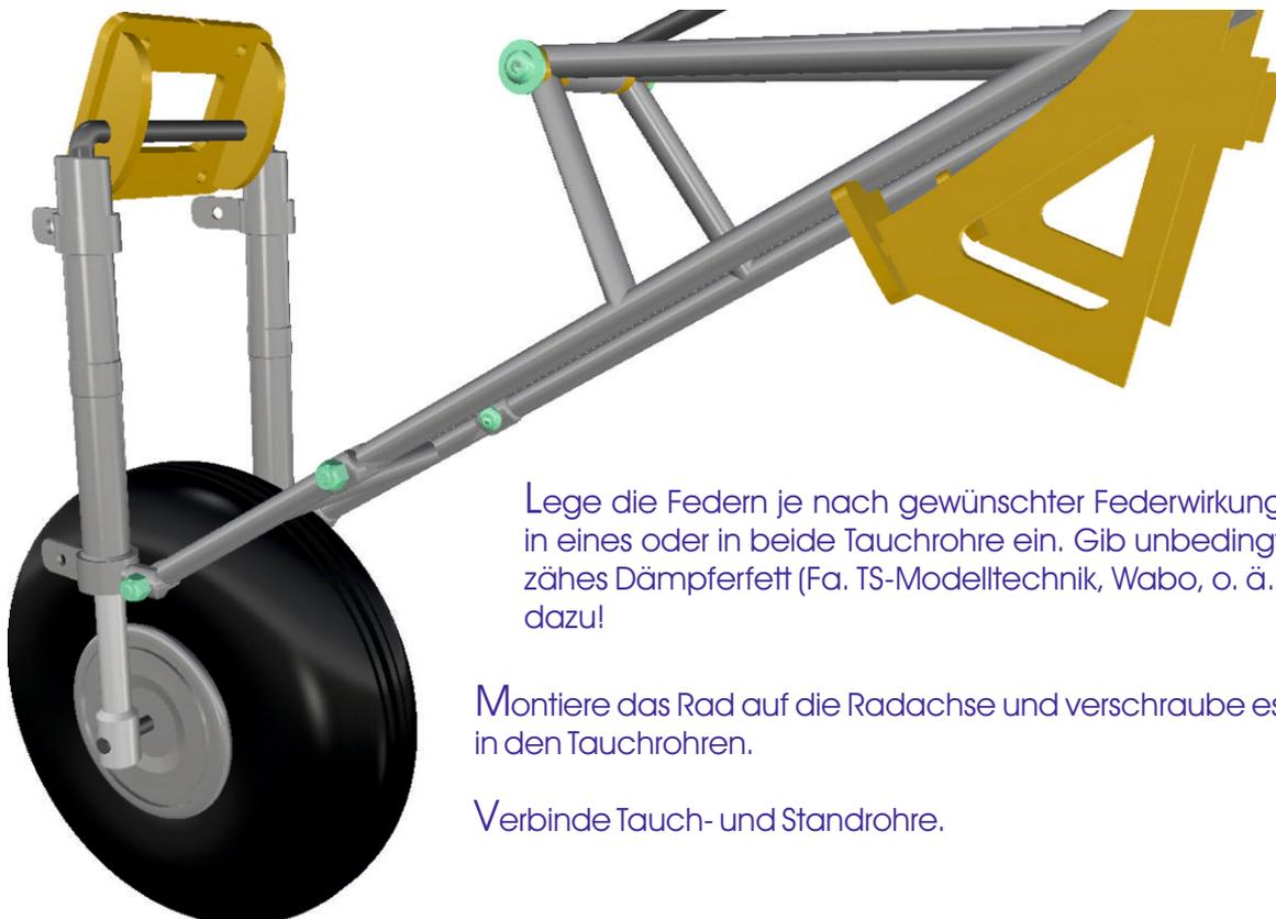
Lege die Federn je nach gewünschter Federwirkung in eines oder in beide Tauchrohre ein. Gib unbedingt zähes Dämpferfett (Fa. TS-Modelltechnik, Wabo, o. ä.) dazu!
