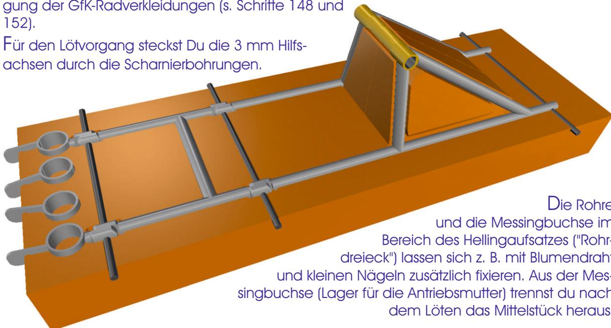
Die Rohre und die Messingbuchse im Bereich des Hellingaufsatzes ("Rohrdreieck") lassen sich z. B. mit Blumendraht und kleinen Nägeln zusätzlich fixieren. Aus der Messingbuchse (Lager für die Antriebsmutter) trennst du nach dem Löten das Mittelstück heraus.
