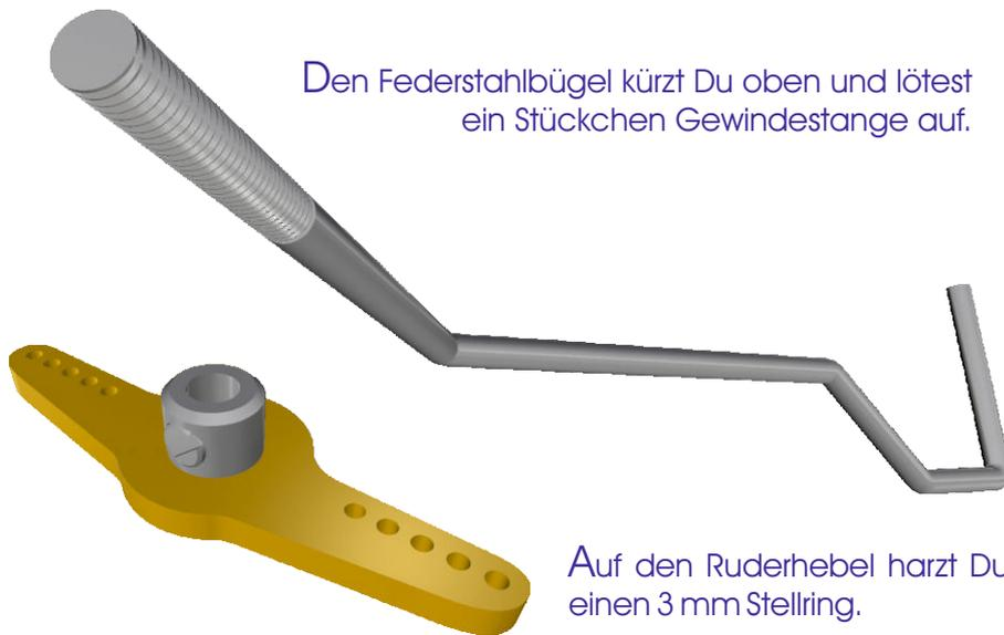
Den Federstahlbügel kürzt Du oben und lötest ein Stückchen Gewindestange auf.
