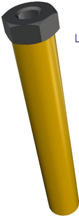
Löte eine M3 Mutter auf ein Messingröhrchen D5 x D3,1, L = 32 mm.
