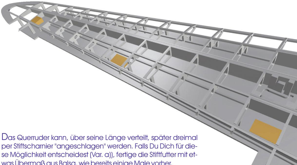
Das Querruder kann, über seine Länge verteilt, später dreimal per Stiftscharnier "angeschlagen" werden. Falls Du Dich für diese Möglichkeit entscheidest (Var. a)), fertige die Stiftfutter mit etwas Übermaß aus Balsa, wie bereits einige Male vorher.
